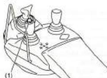
(1) Interruptor de nivelación automática de las horquillas
