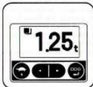
Al pulsa el interruptor del mando de la palanca de elevación o el interruptor del medidor de carga viva (modelos con minipalanca o palanca de mando), se muestra el peso de la carga manipulada en la pantalla de estado. El peso de la carga se muestra en unidades de 0,01 toneladas.
