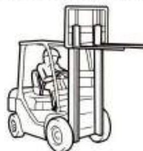
1. Compruebe las horquillas y el respaldo de carga para ver si presentan grietas y deformaciones.
