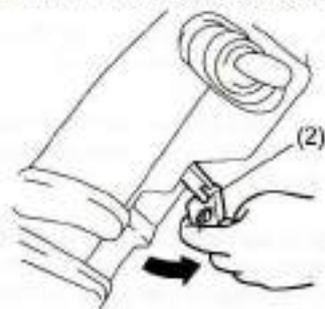
(2) Palanca de desbloqueo del freno de estacionamiento
