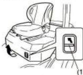
(1) Palanca de desbloqueo de la cubierta del motor
