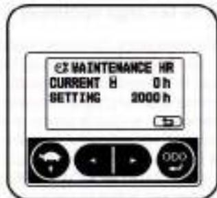
Muestra el tiempo de intervalo de revisión de servicio predefinido y el tiempo actual transcurrido del contador de horas de mantenimiento planificado.
