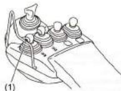
(1) Interruptor del medidor de carga activa
