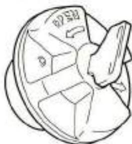
El tapón de combustible se puede bloquear con la llave específica.
