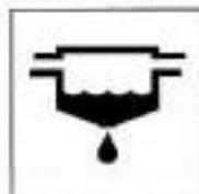
El sedimentador es un dispositivo que permite separar el agua del combustible.
