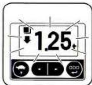
Cuando la carga se eleva a una posición alta, la precisión del medidor de carga baja debido al efecto de deflexión y de fricción del mástil. En este caso, aparece una flecha en el lado izquierdo de la pantalla y la indicación del peso medido parpadea para informar al operario de que la lectura es inexacta.
