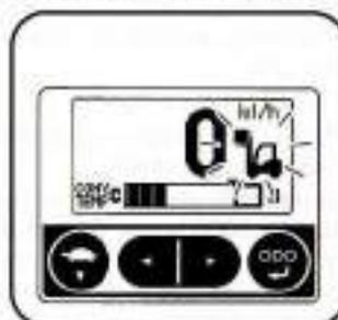
La pantalla multifunción opcional muestra este indicador cuando están activados el Control de velocidad de desplazamiento según la altura de elevación y la carga y la Prevención de arranque repentino según la altura de elevación y la carga. Este indicador también aparece durante un breve periodo de tiempo cuando la llave de contacto se sitúa en ON, para informar al operario sobre la disponibilidad de esta función.
