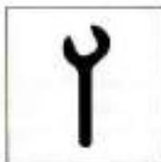
La lámpara indicadora de la llave se ilumina o parpadea cuando se detecta un error en el sistema de control del motor o en el sistema SAS/OPS; aparece un código de error en el área de visualización del contador de horas.
