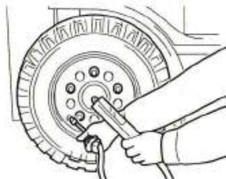
1. Utilice un manómetro para neumáticos para medir la presión de inflado. Ajústela a la presión correcta.
