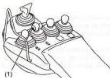
(1) Interruptor de nivelación automática de las horquillas
