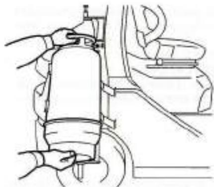
8. Aparte las cintas del depósito y retire el depósito de GLP.
